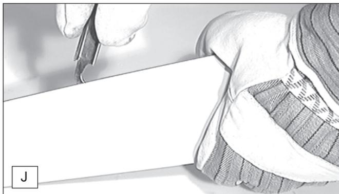
Běžné plochy lišty pily se mají pravidelně kontrolovat na poškození a vhodným náradím očistit.
